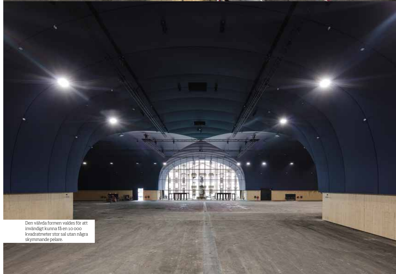
I mittskeppet, där de fyra armarna möts, bildas en mer avancerad geometri som kräver en kraftigare dimensionering av valven.
