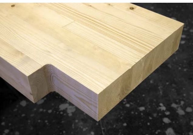
Urtag utan förstärkning utförs lämpligen med rundat innerhorn.
