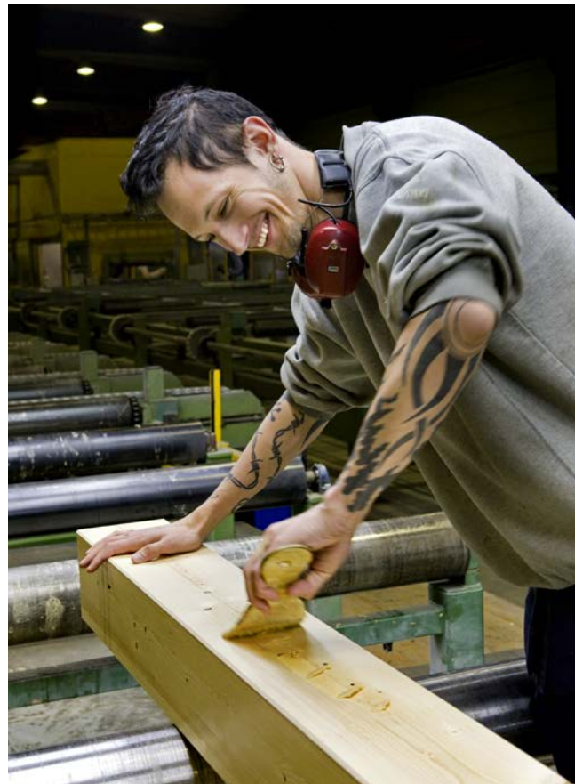
Förbehandling av en limträpelare som ska ytbehandlas hos limträstillverkaren.
