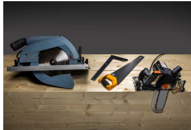
Exempel på vanliga handmaskiner och -verktyg för bearbetning av limträ.
