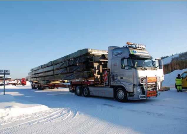
Limträelement lastade på trailerbil för transport till byggarbetsplatsen.
