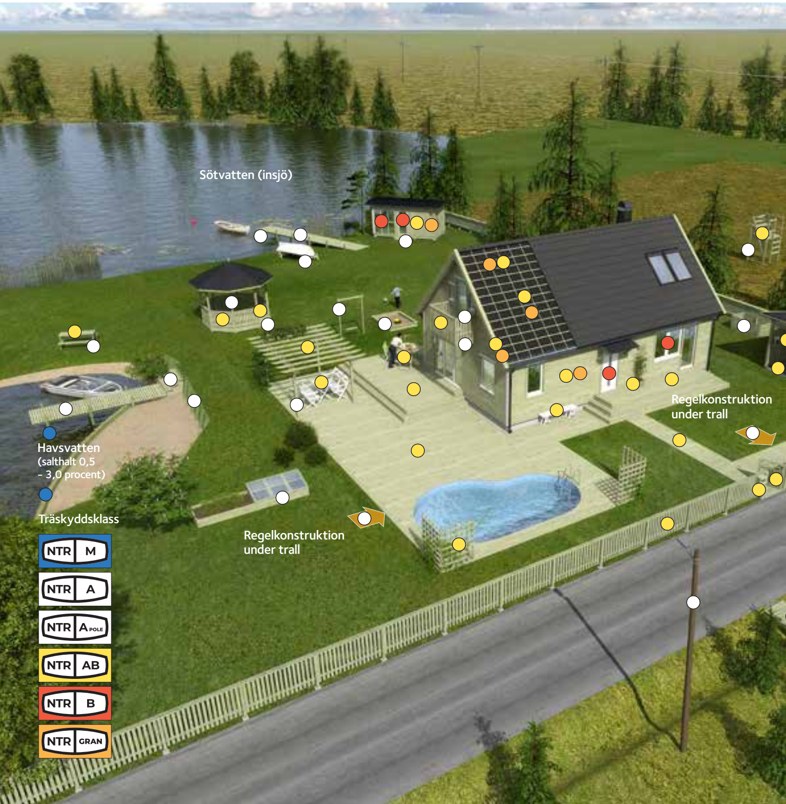
Exempel på användningsområden för olika träskyddsklasser.
